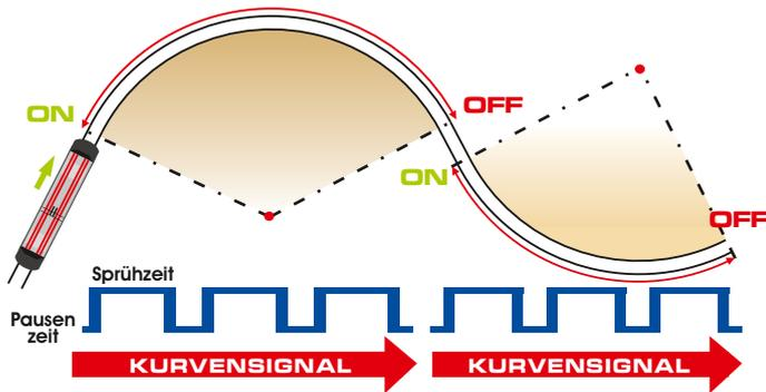
**Funktionsprinzip:** Ein 3/2-Wege-Magnetventil betätigt die Pneumatikpumpe für die eingestellte Sprühzeit. Während dieser Sprühzeit wird eine definierte Menge an Spurkranzschmierstoff aus der Pumpe gefördert und mit der Sprühluft vermischt.
