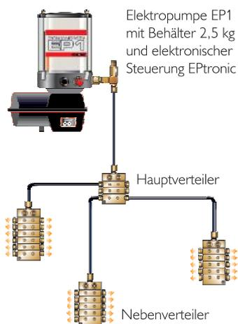
Die elektronische Steuerung der Zentralschmierung wird an die Betriebsbedingungen des Fahrzeugs angepasst und aktiviert die Pumpe in einem festgelegten Intervall.
